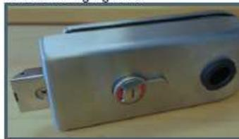
Im verschlossenen Zustand ist der Drücker ausgekoppelt und es kann somit die Türe nicht geöffnet werden. Von außen ist jedoch eine Notöffnung per Schlitzschraubendreher oder Münze jederzeit möglich. Beim entriegeln der Türe darf der Drücker während der Zylinderdrehung nicht gleichzeitig herunter gedrückt werden, da er sich sonst nicht einkoppeln kann.
